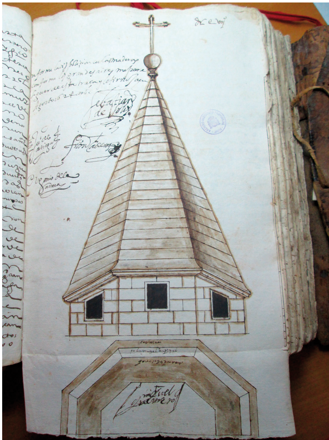
Jaén. Iglesia de San Ildefonso. Planta y alzado del chapitel trazado por Sebastián de Solís. Año 1624. (Dibujo publicado por D. Manuel López Molina)
